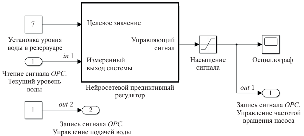
Рис. 3. Блок подсистемы с нейросетевым предиктивным регулятором.
