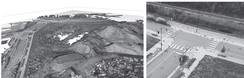
Рис. 1. Слева полигональная сетка (3D-модель) поверхности ландшафта, полученная в результате фотограмметрии. Справа участок исходного изображения, где окружности – позиции особых точек или SIFT-признаков для сопоставления и триангуляции в оптимизационной задаче фотограмметрии.
