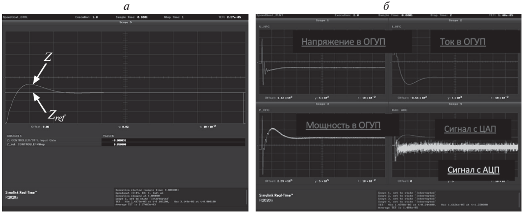
Рис. 5. а — Переходная функция системы управления от ступенчатого воздействия 5 см в реальном времени; б — сигналы напряжения, тока и мощности в ОГУП и сигналы с АЦП и ЦАП от ступенчатого воздействия 5 см в реальном времени.
